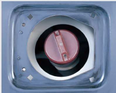
耐水ペーパーを使用した研磨面 (形状に合わずに研ぎ残しのあるプレス部)
