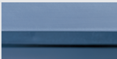
アシレックス レモンを使用した研磨面 (電着プライマーを剥がずに研磨されたエッジ部)
