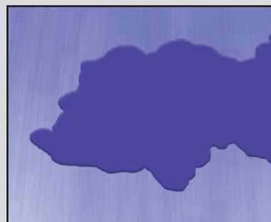
アシレックスピーチを使用した研磨面 (ワックスが取り除かれて水をはじかない状態)
