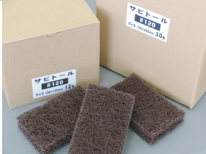
極太ナイロン不織布に研磨砥粒を付着させてありますのでクッション性があり、スムーズな研磨作業が行えます。また目詰まりを起こさず、曲面にも良くなじみます。
