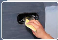
←凹凸部の研磨面 (形状通りに研磨されたプレス部)
